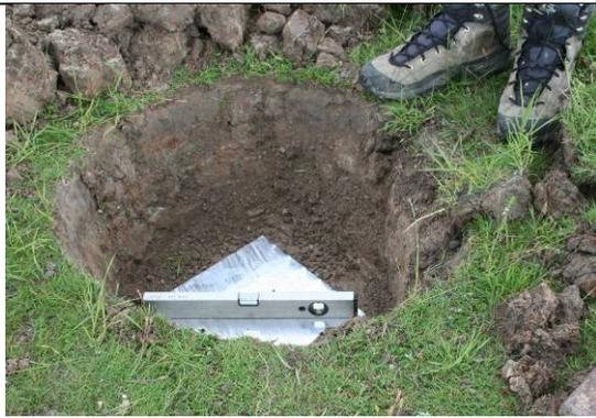
**Abb. 46:** Horizontal verlegte SEP-Platte.
