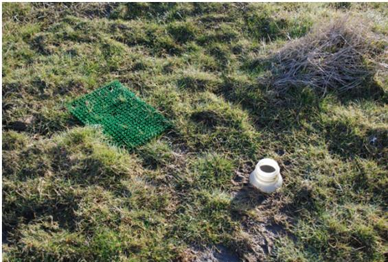
**Abb. 3:** Sedimentfallekombination aus PVC-Fußmatte und 1 l-PE-Flasche
