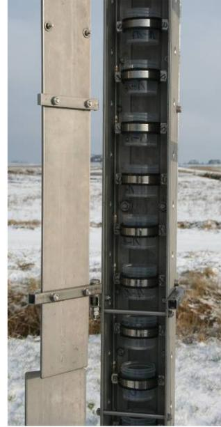
**Abb. 50:** Probenahmebecher im Inneren eines Tassenpegels
