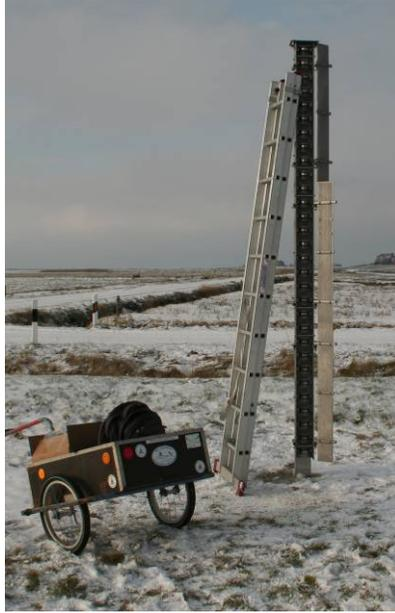
**Abb. 49:** Tassenpegel im Versuchsfeld B mit geöffneten Frontklappen
